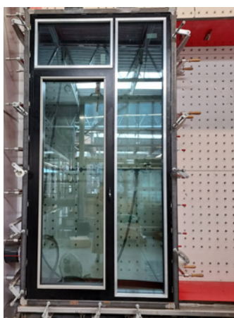
Stanowisko do testowania parametrów ścian ostonowych, okien i drzwi
