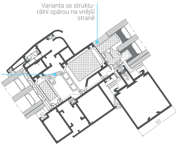
Řez střešního okna ve strukturální fasádě
